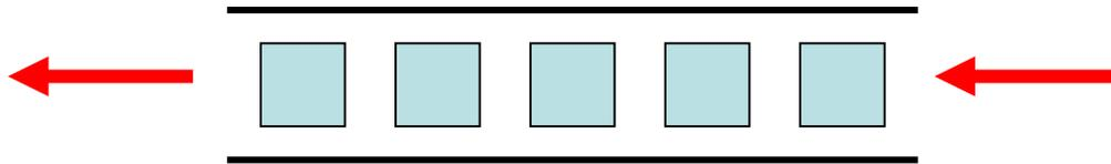
D.h. eine Queue  $Q$  implementiert die **FIFO-Regel** (FIFO: first in first out).
