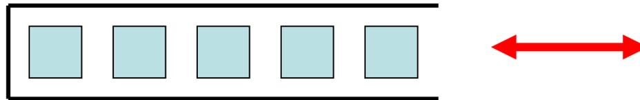
D.h. ein Stack  $S$  implementiert die **LIFO-Regel** (LIFO: last in first out).
