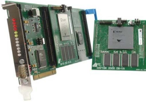
**Figure 10. RAPTOR2000 Rapid Prototyping System**
